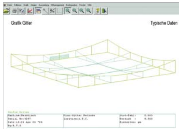
Так выглядят результаты проверки плоскостности по методу сетки
